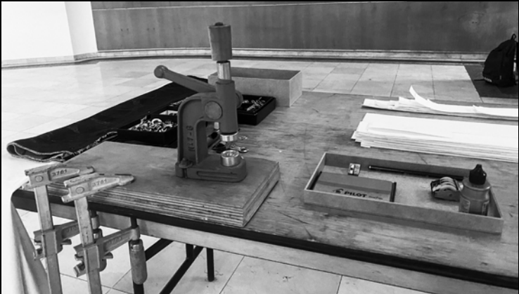
Balancim manual, dois sargentos para fixação na bancada, almofada e tinta preta para carimbo, datador, lápis e apontador.
